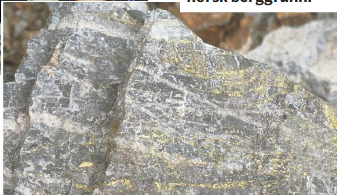
Skatten: Gull og kobber mineralisert i albittfels fra Bidjovagge gull- og kobberforekomst i Finnmark. Foto: Jan Sverre Sandstad/NGU
